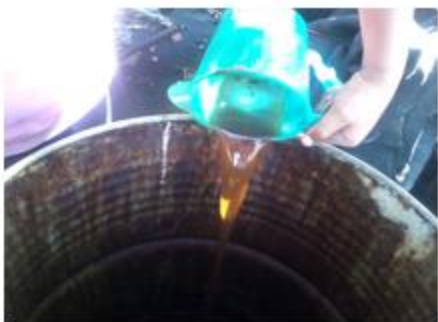
Figura 5 Almacenamiento del biodiesel crudo
